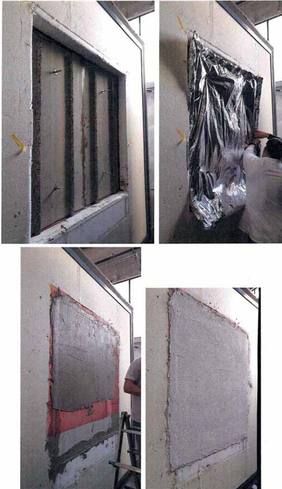
Fig. 1. Il campione in prova in fase di posa
