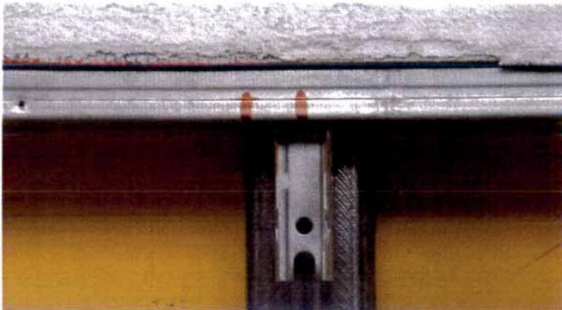
Figura 13: Particolare dello scorrimento del traverso alla base del campione rispetto al montante, evidenziato durante le prove quasi statiche e dinamiche.
