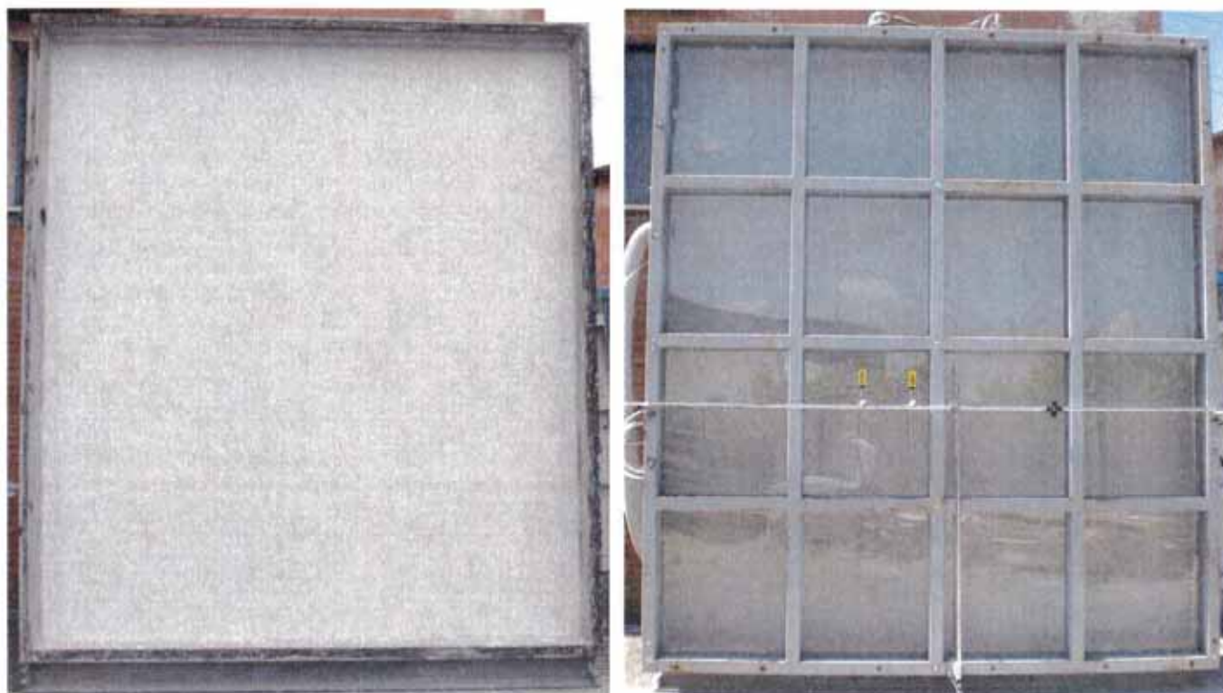
Foto 19 e 20: Campione sottoposto a prova nell'assetto sperimentale e durante i cicli di pressione
